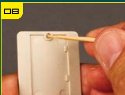
С помощью зубочистки нанесите немного секундного клея в гнездо на краю съемной панели.
